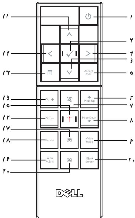
يستخدم هذا الزر في تشغيل جهاز الإسقاط أو إيقاف تشغيله. لمزيد من المعلومات، يرجى الرجوع إلى "تشغيل جهاز الإسقاط" صفحة ٢٥ و "إيقاف تشغيل جهاز الإسقاط" في صفحة ٢٥.
