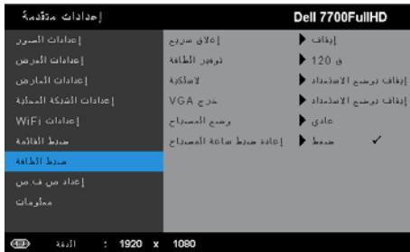
**إغلاق سريع—حدد تشغيل لاغلاق جهاز الإسقاط بضغطة واحدة على زر Power (الطاقة)،** حيث تتيح هذه الوظيفة إمكانية إيقاف تشغيل جهاز الإسقاط بسرعة مع تزايد سرعة المروحة. ويتوقع ارتفاع صوت الجهاز أثناء تنفيذ هذه العملية.
