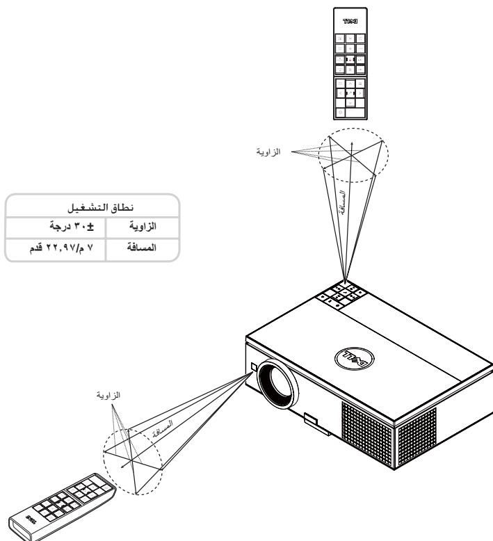
**ملاحظة:** قد يختلف نطاق التشغيل الفعلي إلى حد ما عما ورد بالرسم التوضيحي، كما تحول البطاريات الضعيفة دون تشغيل وحدة التحكم عن بعد للجهاز بصورة صحيحة.
